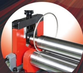
溝加工(オフショウ)により、 丸棒の加工もできます!
