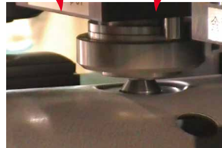
缶体を自動搬送し、パリング加工を行うマシン
