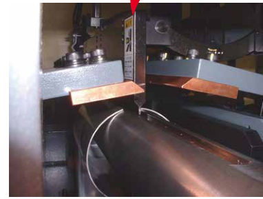
自動で溶接(直線溶接)するマシン
