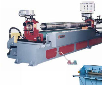
ロール有効幅 3000mm 列車内装パネル製造マシン
