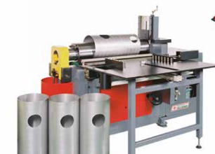
トランス製造マシン
