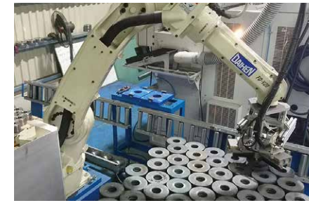
フランジ加工機へ材料を供給し、製品を取り出し整列させるマシン
